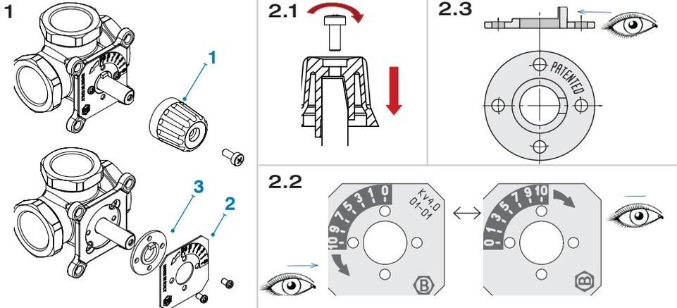
NB: si consiglia di modificare la configurazione della valvola prima di installarla sull'impianto per verificare il corretto funzionamento del rotore.
